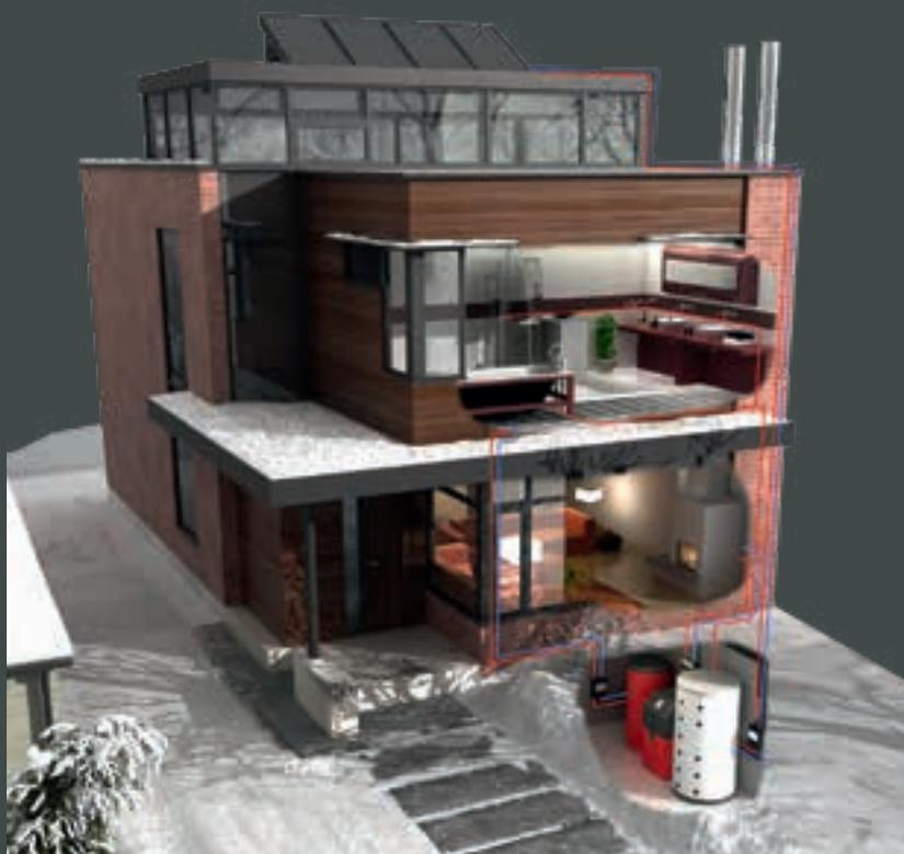
Sección de una celda de quemado conductora de agua integrada en el sistema de calefacción
