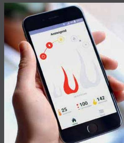
El asistente electrónico proporciona información acerca del rendimiento, el estado de funcionamiento y la temperatura ambiental y de la chimenea.
